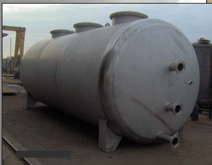
Serbatoi per stoccaggio per acido peracetico. Storage tanks for peracetic acid.
