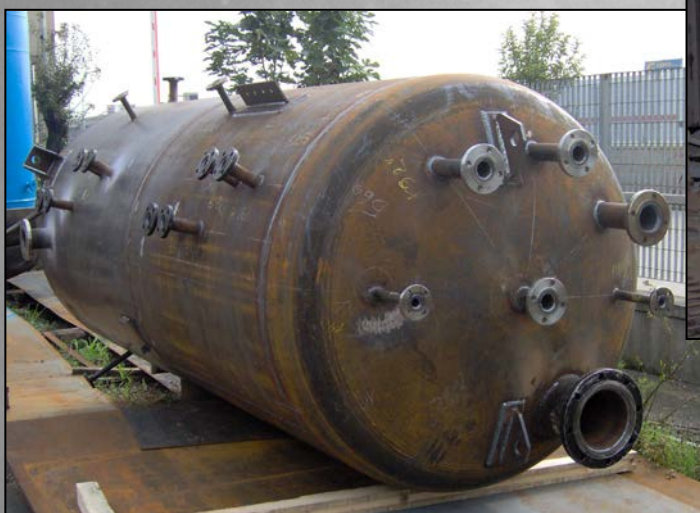
Serbatoi in pressione per impianto petrolchimico. Pressure vessels for petrochemical plant.
