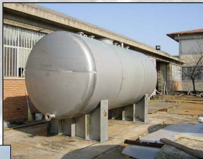
Serbatoi per stoccaggio per acido peracetico. Storage tanks for peracetic acid.
