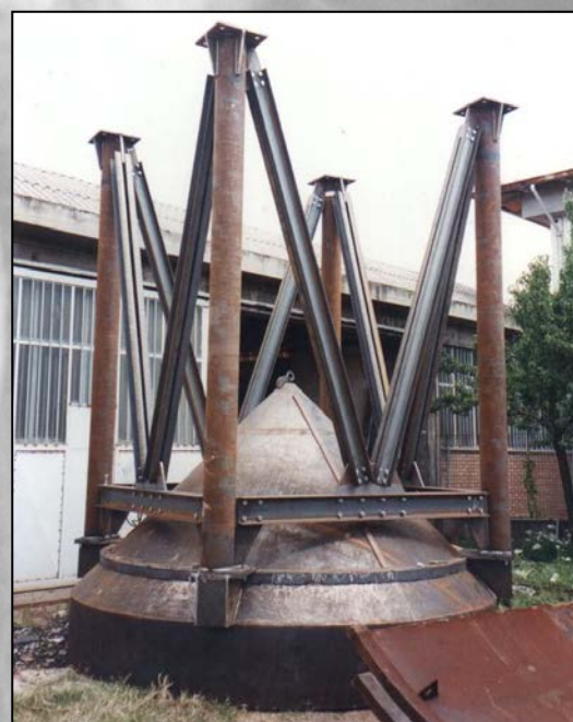
Base di appoggio decantatore Ø4.000. Support for decanter Ø4.000.
